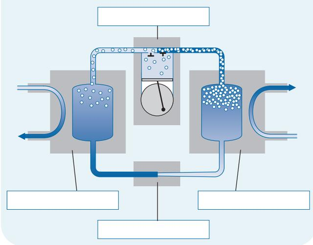
komprimiert es. Aufgrund des Druckanstiegs steigt die Temperatur des Kältemittels. Anschließend verflüssigt sich das Kältemittel wieder und gibt dabei Wärme an die aus dem Verdampfer kommende Prozessluft ab. Der Druckabbau erfolgt durch ein Expansionsventil. Das flüssige Kältemittel wird wieder zum Verdampfer geführt und der Kreislauf beginnt von Neuem.
